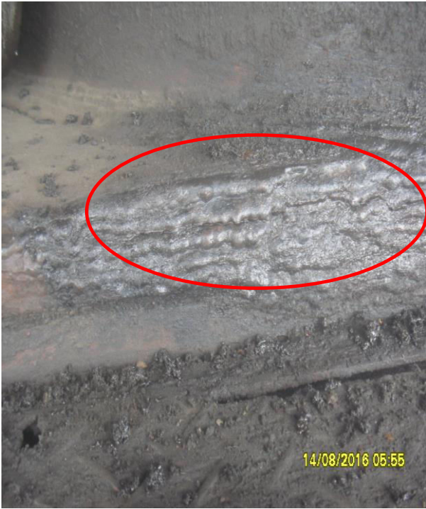
旋轉支持體焊道裂痕
